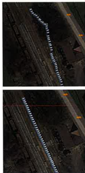
Vergleich der gemessenen Daten mit einem herkömmlichen GPS (oben) und einem externen differentiellen GNSS-Empfänger (unten).
