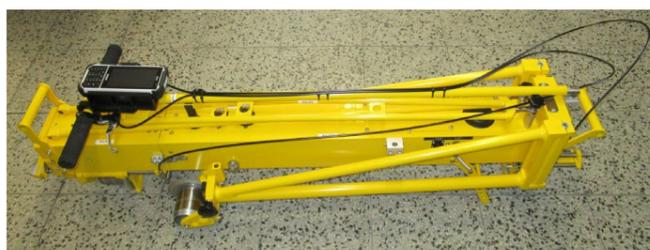
Für einen leichteren Transport kann der Wagen leicht zusammengefaltet werden.
