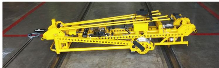
Für einen leichteren Transport kann der Wagen leicht zusammengeklappt werden
