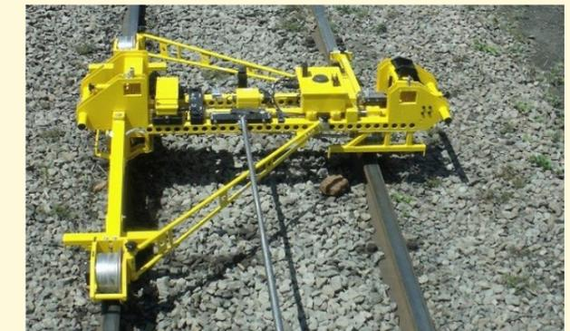
Insbesondere an Stellen, wo das Anhängen des Gerätes nicht praktikabel ist, kann der Kleinmesswagen Krabbe 84.09SA wie üblich manuell eingesetzt werden. Dies betrifft z. B. Bahnhofsgleise, Anlagen mit vielen Weichen oder Gleise in einem sehr schlechten Zustand wo die Befahrung im angehängten Zustand ein hohes Entgleisungsrisiko mit sich bringt.
