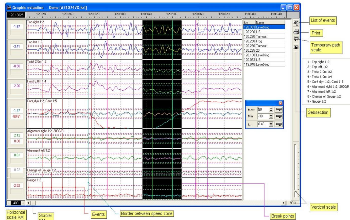
Ein Beispiel eines Gleisgeometrie Graphs ausgedruckt von der Auswertungssoftware
