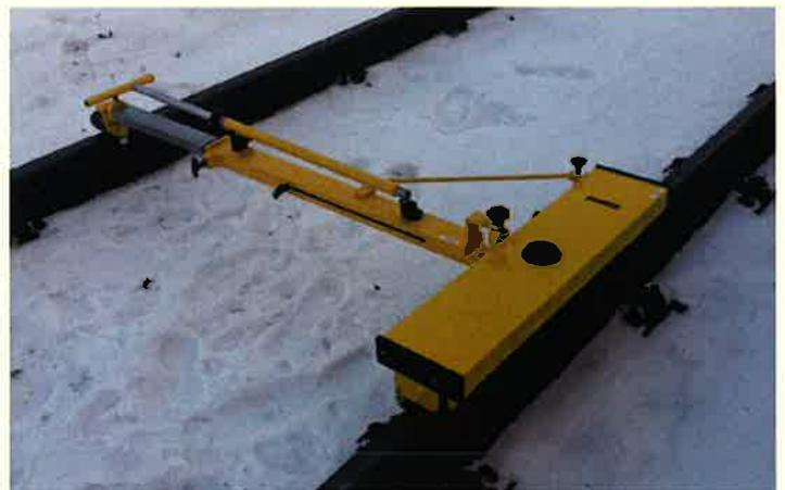
**Der GEKON ist in der Lage eine Reihe von kontinuierlichen Gleisabschnitten zu messen. Die erfassten Daten werden bewertet und die Ergebnisse gemäß der Norm EN 13231-3 berechnet. Für die Messung verwendet der GEKON zwei Reihen mit Lasersensoren, die senkrecht zur Längsachse der Schiene platziert sind.**
